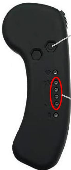
Appuyer 2 fois rapidement sur le bouton on/off pour vérifier le niveau de batterie
