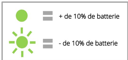
**Indicateur ponctuel** : grâce aux 4 voyants lumineux, il est possible de connaître avec précision le niveau de batterie de la télécommande. Appuyez deux fois de suite rapidement sur le bouton on/off. Les voyants s'allument alors pendant 3 secondes. Suivant le nombre de voyants qui s'allume, on obtient le niveau de batterie plus précis de la télécommande.
